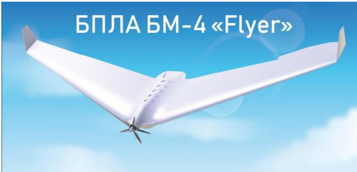
Беспилотный летательный аппарат, выполненный по схеме «летающее крыло», разрабатывают в подмосковной Балашихе. Новый беспилотник, получивший название БПЛА БМ-4 «Flyer» (размах крыла -21,5 м, дальность действия – от 1 100 до 1 900 км), будет оснащен пятитилопастным винтом изменяемого шага и отечественной силовой установкой, обеспечивающей на взлётном режиме летательному аппарату мощность до 300 кВт.
